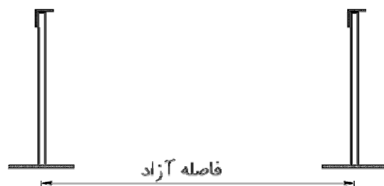
شکل ۸-۲- فاصله‌ی آزاد بین تیرچه‌های فولادی
