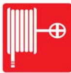
شلنگ اطفای حریق
